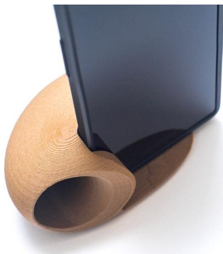
Slika 1.7 – Jedinstven „egzotični“ izgled PLA materijala s drvenom i metalnom ispunom ( https://www.core77.com/posts/71173/How-To-Find-the-Best-3D-Printing-Material-for-Your-Designs )
