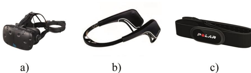
Slika 40: Oprema korištena u istraživanju a) HTC Vive, b) Muse EEG c) Polar H10 prsna traka
