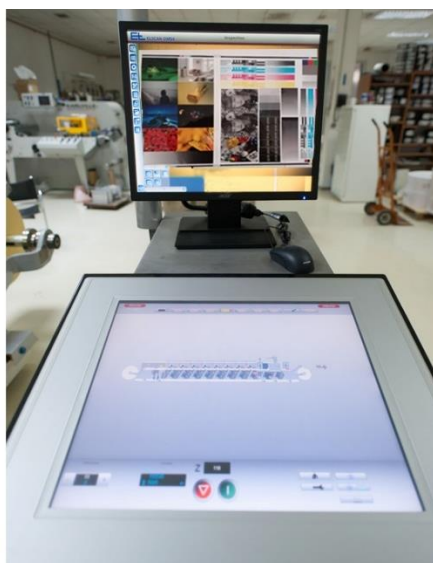
Slika 33. Upravljačka centralna konzola stroja Nilpeter FA 4, Izvor: Grafplex d.o.o
