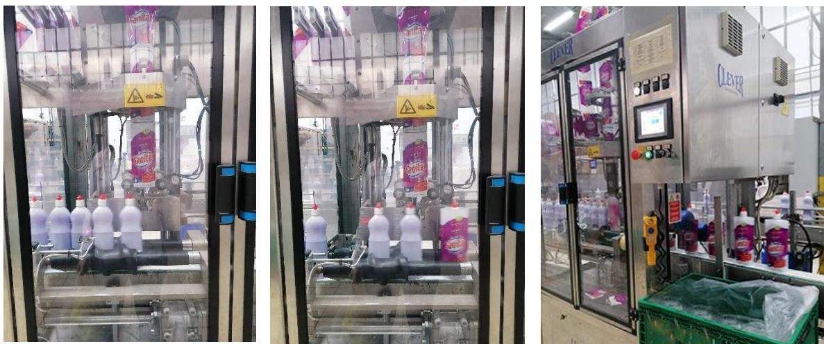
Slika 38. Sliviranje plastične ambalaže termoskupljajućom etiketom, Izvor: Meteor Grupa – Labud d.o.o.
