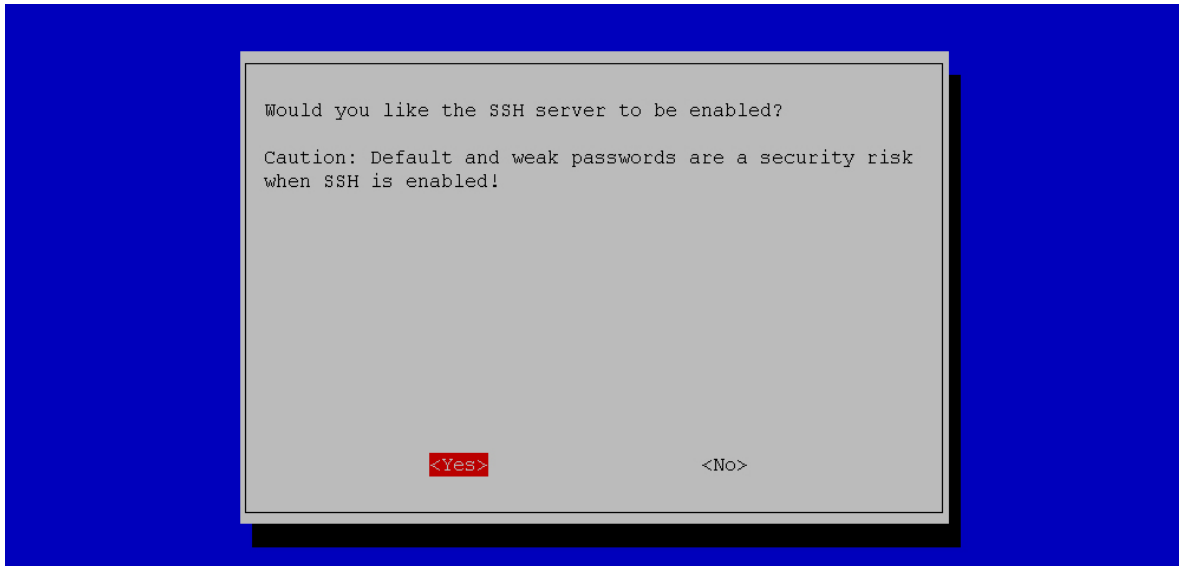
Slika 10. Pokretanje SSH poslužitelja pomoću konfiguracijskog alata raspi-config
