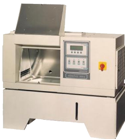
Slika P5.12. Solarbox 1500e komora (poglavlje 3.2.13.)
