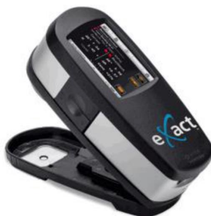
Slika 47. Spektrofotometar X-Rite eXact
