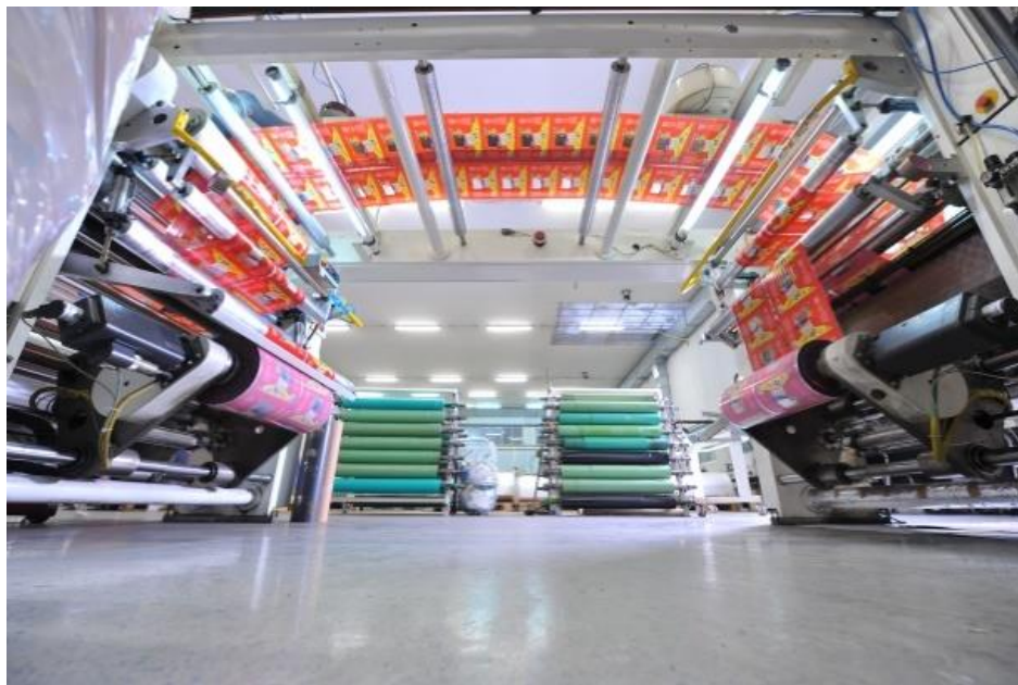
Slika 2.12. Kaširanje na stroju Nordmeccanica Super Simplex.
