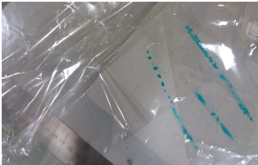
Slika 2.11. Obostrano obrađeni PET, označen testnom tintom za poliestersku foliju.
