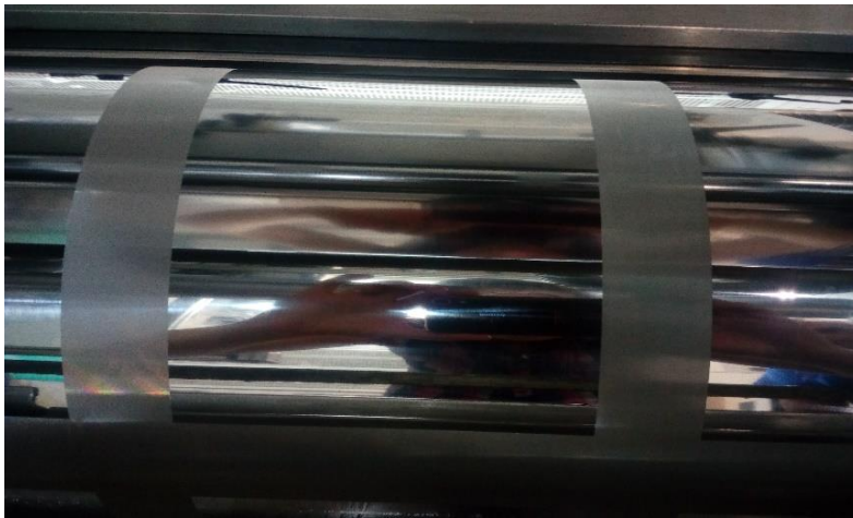
Slika 2.13. Gravirani valjak za nanos hladnog vara.
