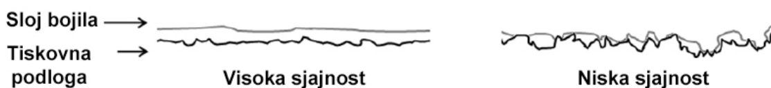
Slika 2.25. Ovisnost sjajnosti otiska o površinskoj strukturi tiskovne podloge: a) blago hrapava tiskovna podloga rezultira glatkim i sjajnim otiskom; b) hrapava tiskovna podloga rezultira otiskom male sjajnosti [40]
