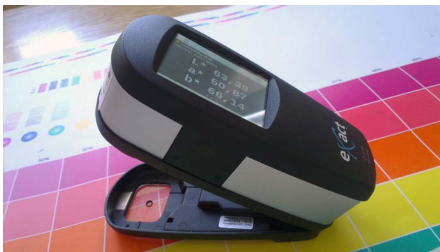
Slika 3.24. Mjerni uređaj X-Rite eXact
