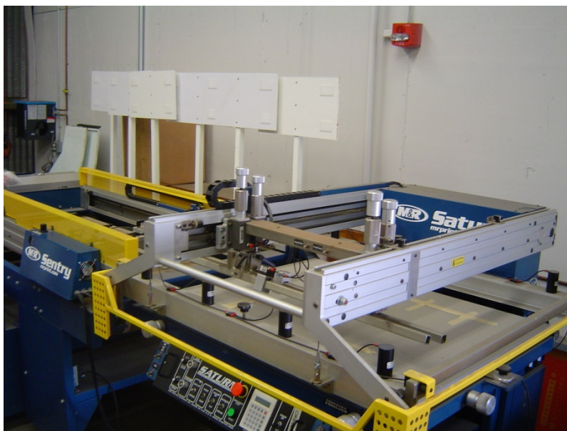
Slika 3.21. Sitotiskarski stroj M&R Saturn
