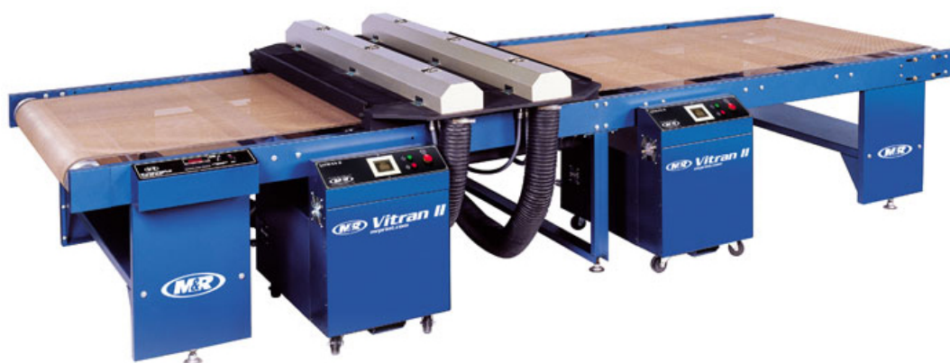
Slika 3.22. VITRAN II dodatak s UV lampama [91]
