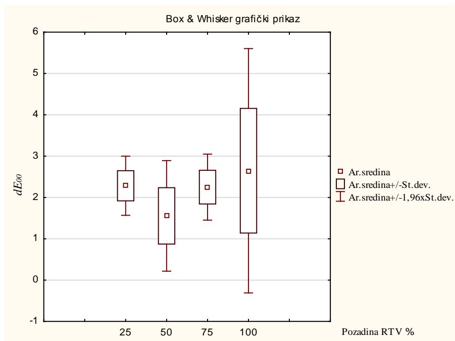
Slika 4.43. Box i Whisher grafički prikaz odstupanja u percipiranoj razlici boja \Delta E_{00} za efekt desaturiranog nabiranja za primarni stimulus 45% RTV na relaciji CIP3-atlas boja na premazanoj podlozi
