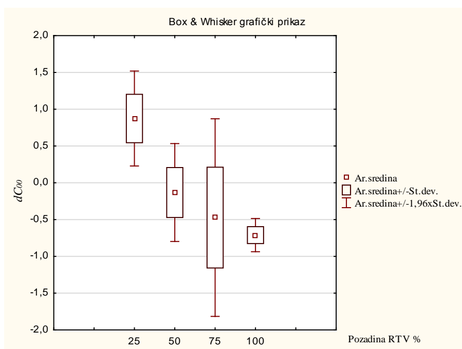
Slika 4.58. Box i Whisher grafički prikaz odstupanja u percipiranoj razlici kromatičnosti \Delta C_{00} za efekt desaturiranog nabiranja za primarni stimulus 45% RTV na relaciji CIP3-atlas boja na nepremazanoj podlozi
