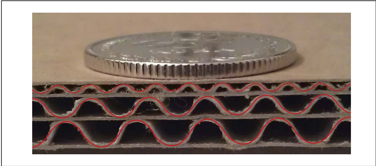
Slika 8. Sedmeroslojni valoviti karton, D val-29 valova/cm, C val-13 valova/cm, A val-11 valova/cm
