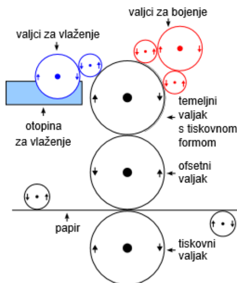
Slika 4-3. Princip rada stroja za ofsetni tisak
