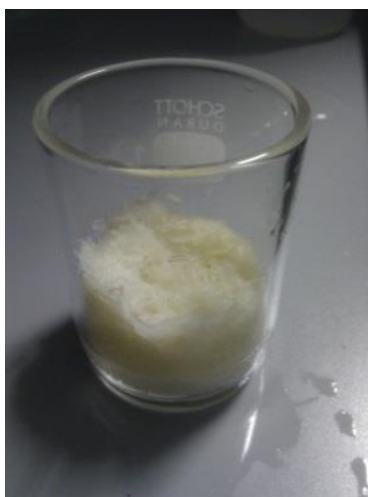
Slika 25. Dobiveni uzorak \alpha -celuloze (Zavod za tehnologije materijala, Sveučilište u Zagrebu, Šumarski fakultet)
