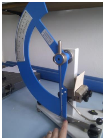
Slika 32. Uređaj za određivanje otpornosti prema cijepanju (Katedra za materijale u grafičkoj tehnologiji, Sveučilište u Zagrebu, Grafički fakultet)
