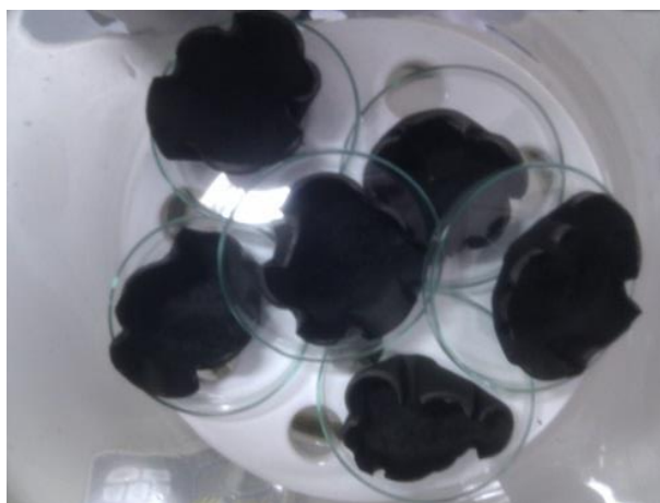
Slika 23. Dobiveni uzorak lignina (Zavod za tehnologije materijala, Sveučilište u Zagrebu, Šumarski fakultet)
