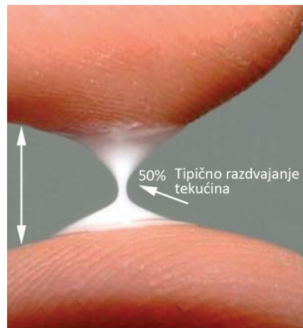
Slika 2.43 Prikaz fenomena razdvajanja ljepila između dva prsta može se povezati s prijenosom bojila između dviju površina tijekom tiskovnog procesa [57]
