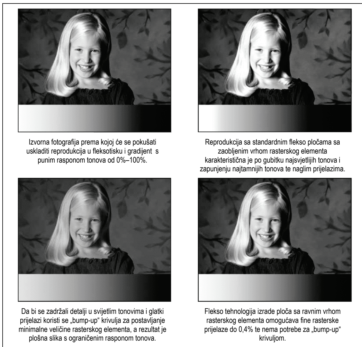
Slika 2.23 Različiti pristupi svladavanja ograničenja u fleksotisku, za postizanje reprodukcije slične ofsetnom tisku [47]
