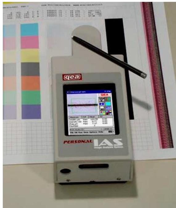
Slika 72: Analizator slike (Personal Image Analysis System-IAS)
