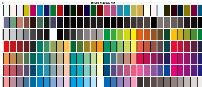
Slika 29. Kontrolni strip za određivanje volumena gamuta
