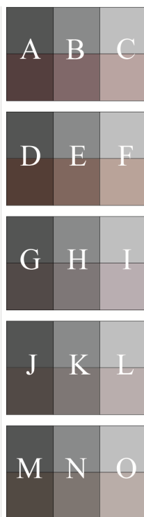
Slika 51. Kontrolni strip za određivanje optimalnog sivog balansa
