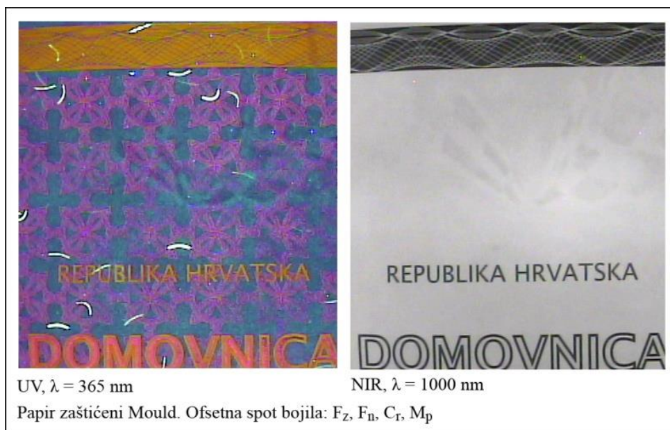
Slika 11.4.b. Barijerno skeniran otisak Domovnice 4 , UV i NIR stanje
