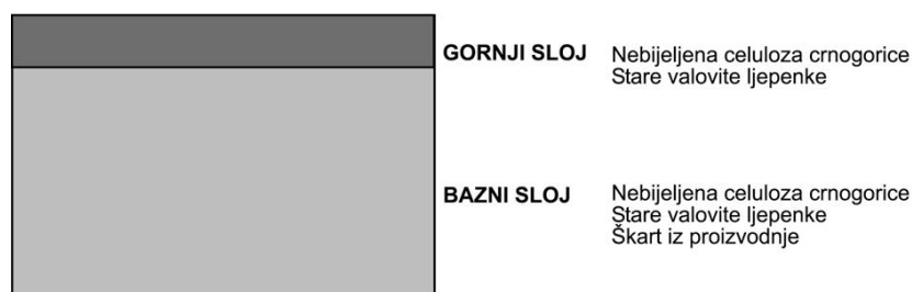
Slika 14. Shematski prikaz smeđeg testlinera
