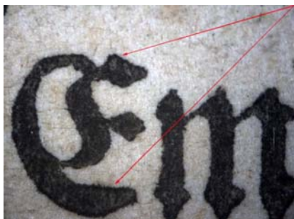
Slika 4 Tipografski elementi otisnuti knjigotiskom, detalj švedske novčanice iz 1717.godine, inv.br. G1397. Imitacija bijelog svjetla, mikroskop.
