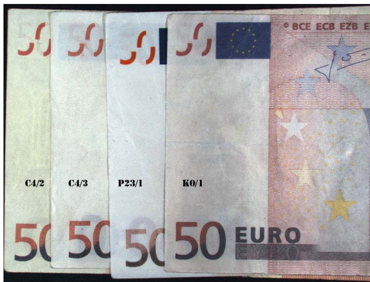
Slika 34 Detalji krivotvorenih novčanica indikativa C4 broj 2 i 3, P23 broj 1 i K0 broj 1 skanirani pod uvjetom WHITE 100% u video spektralnom i označeni u programu Photoshop, bez korekcije slika
