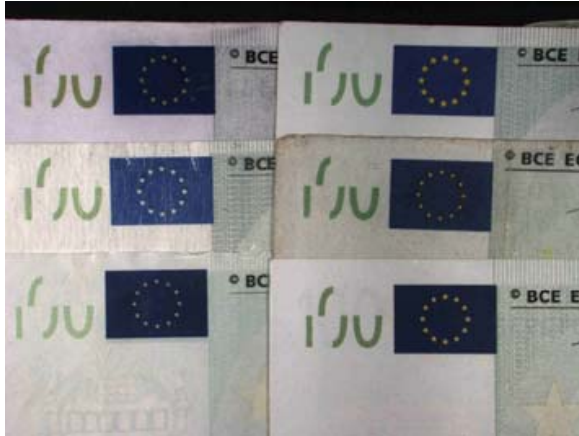
Slika 73 Komparacija krivotvorenih novčanica od 100 eura indikativa L0 (gore lijevo), P16 (sredina lijevo), P15 (dolje lijevo), P3 (gore desno), C6 (sredina desno) i P12 (dolje desno).
