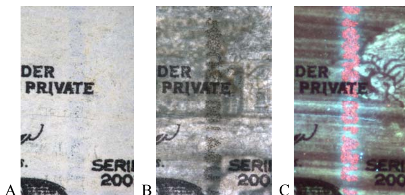
Slika 40. Skenirani detalj krivotvorene novčanice od 100 USD, indikativa 22879B. Imitacija bijelog svjetla (A), propusno svjetlo (B) i UV svjetlo 365 nm (C).
