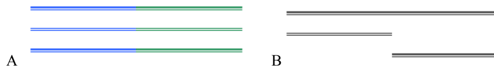
Slika 92 Kontinuirani prijelaz boje na vidljivom svjetlu (A) i pod IR svjetlom od 830 nm (B).
