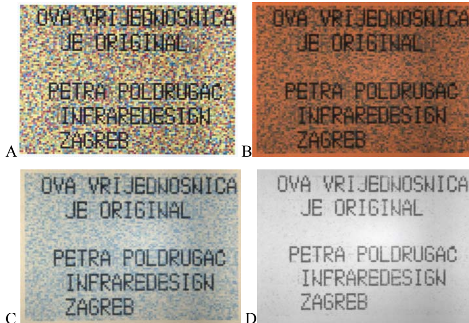
Slika 110 Imitacija objekta pod bijelim svjetlom (A), 630 nm (B), 715 nm (C) i 830 nm (D).
