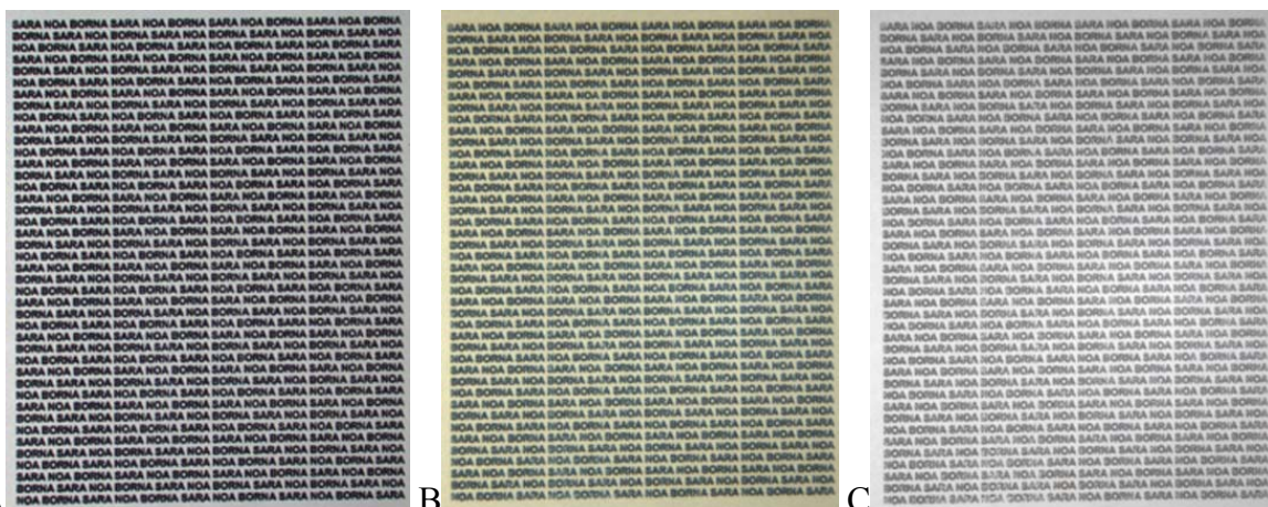
Slika 104 Imitacija objekta pod bijelim svjetlom (A), 715 nm (B) i 830 nm (C).
