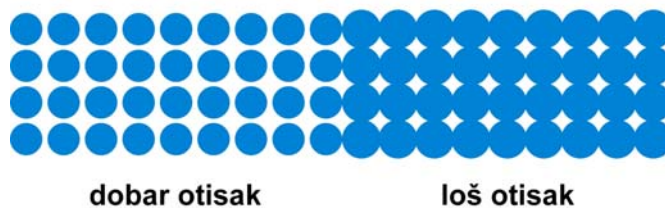
Slika 49: Utjecaj prirasta rasterskog elementa na kvalitetu reprodukcije
