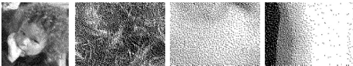
Slika 44: reprodukcija FM rasterskom tehnologijom
