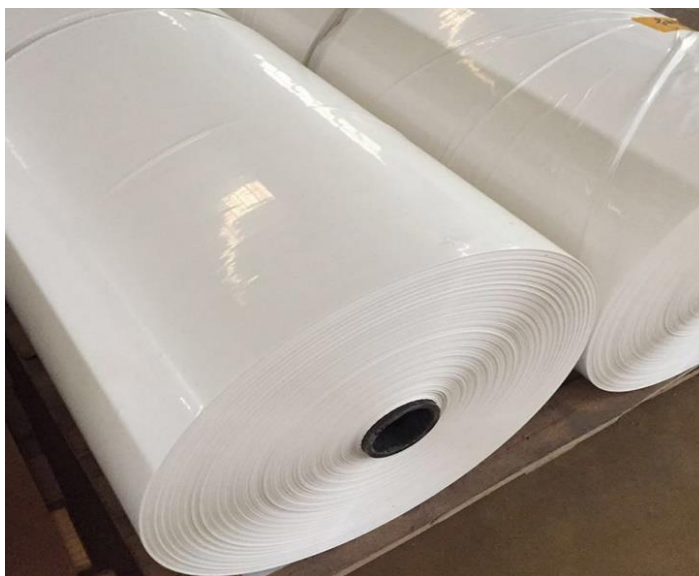
Slika 32. LDPE film (60 µm) u roli Izvor: http://diriplast-srl.commerciointalia.it/
