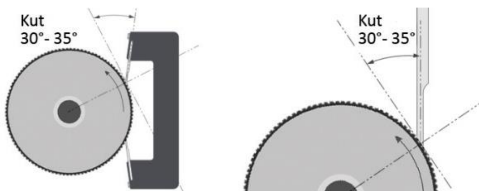
Slika 17. Kut oštrice rakela prema aniloks valjku kod dva različita sustava za obojenje Izvor: Upute i opis za rukovanje, Strojevi za fleksotisak UF – 6509 – INTRO, Aluflexpack d.o.o., Zadar
