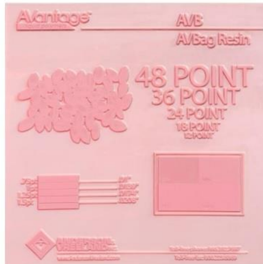
Slika 1. Flekso tiskovna forma od polimera
