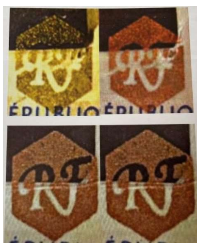
Slika 46. Izvoran OVI-element (gore) i njegova imitacija (dolje)
