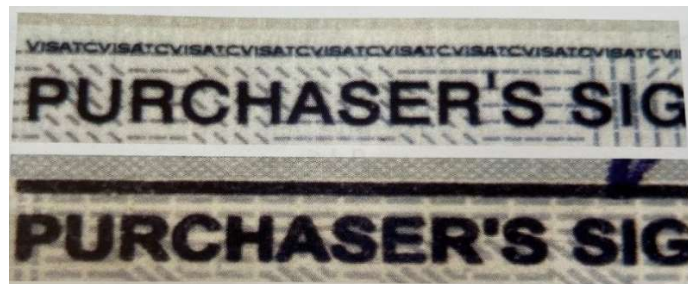
Slika 44. Linija za potpis s mikrotiskom na izvornom čeku (gore) i linija za potpis imitiranog mikrotiska na krivotvorenom čeku (dolje)
