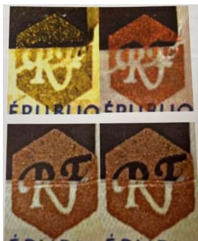
Slika 46. Izvoran OVI-element (gore) i njegova imitacija (dolje)
