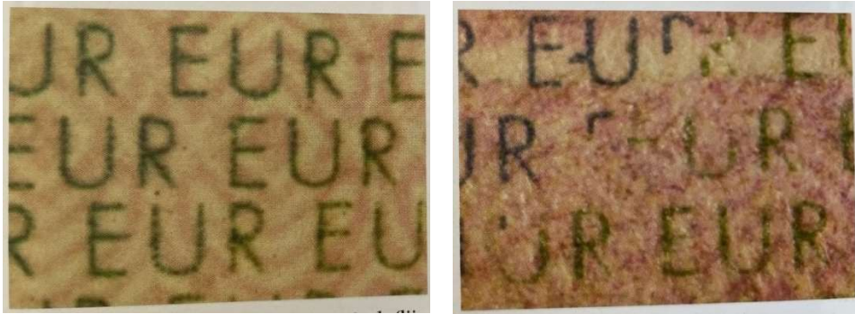
Slika 41. Izvorni iris-tisak (lijevo) i imitirani iris-tisak (desno)
