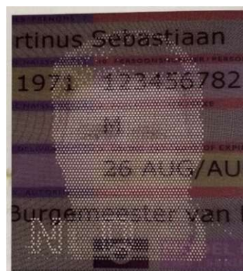
Slika 30. Laserski perforirani zaštitni element u obliku sekundarne fotografije na putovnici
