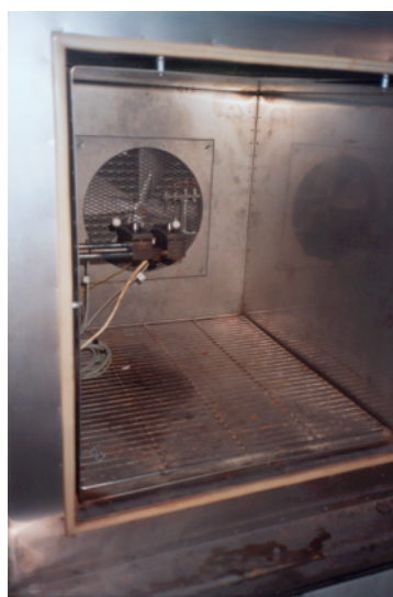
Slika 53. Hidrometerološka komora VUK 08/500
