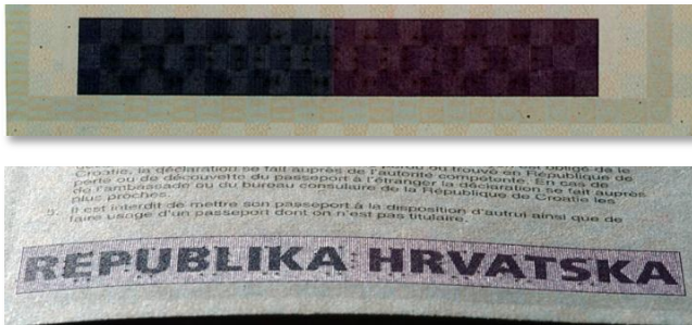
Slika 12 - Primjer latentne slike zalista putne isprave RH otisnute intaglio tehnikom tiska (izvor: AKD)
