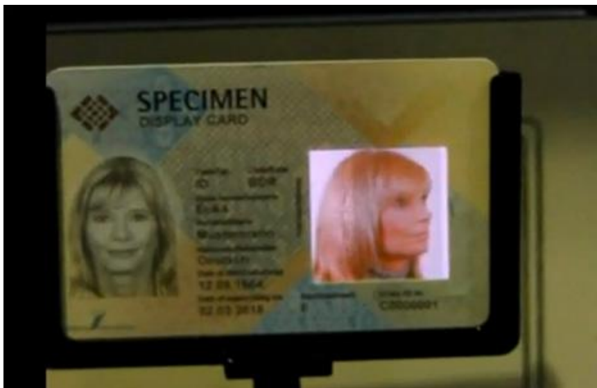
Slika 23 – OLED zaslon tvrtke Bundesdruckerei GmbH
