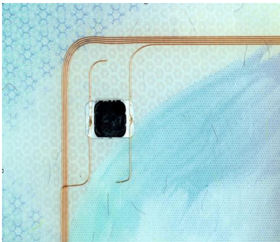
Slika 29 – Spoj antene i čipa
