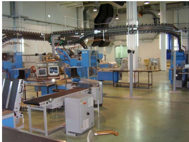
Slika 11. Novinska otprema s transportnim trakama
