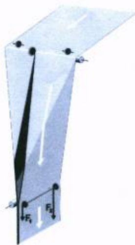
Slika 17. Smjer trake papira na lijevku
