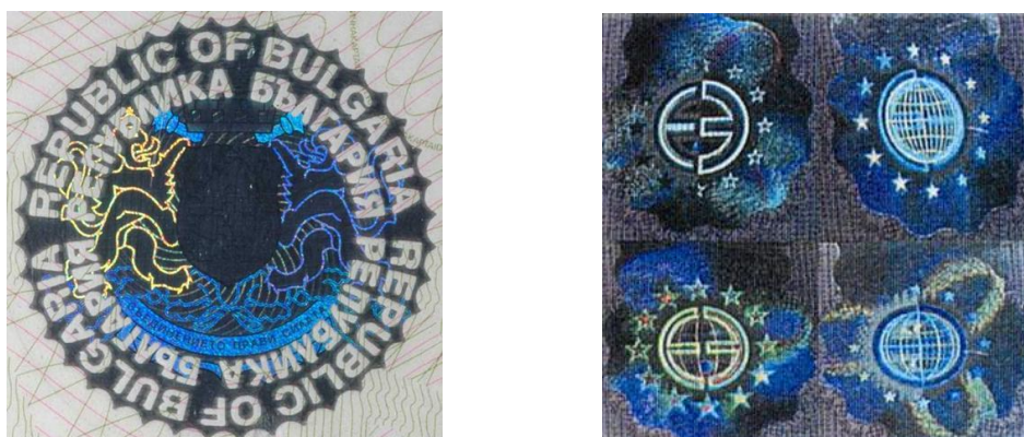
Slika 24: Parcijalno demetaliziran i potpuno metaliziran Kinegram®
