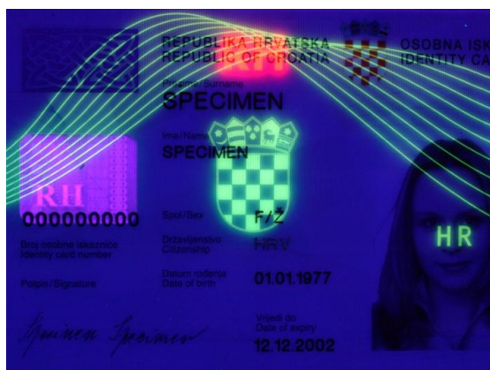
Slika 13: Žutozeleni i crveni UV luminiscirajuća boja na OI RH (izvor AKD)
