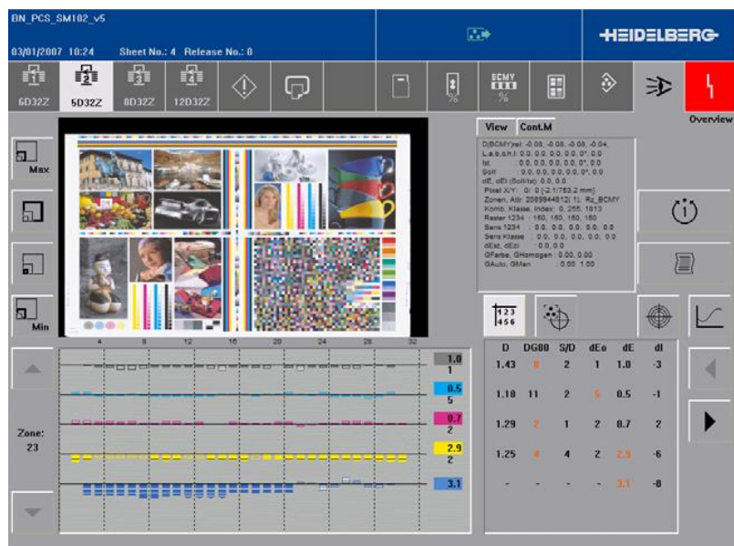
Slika 46: Prikaz podataka o boji „Prinect Image Control“ modula
