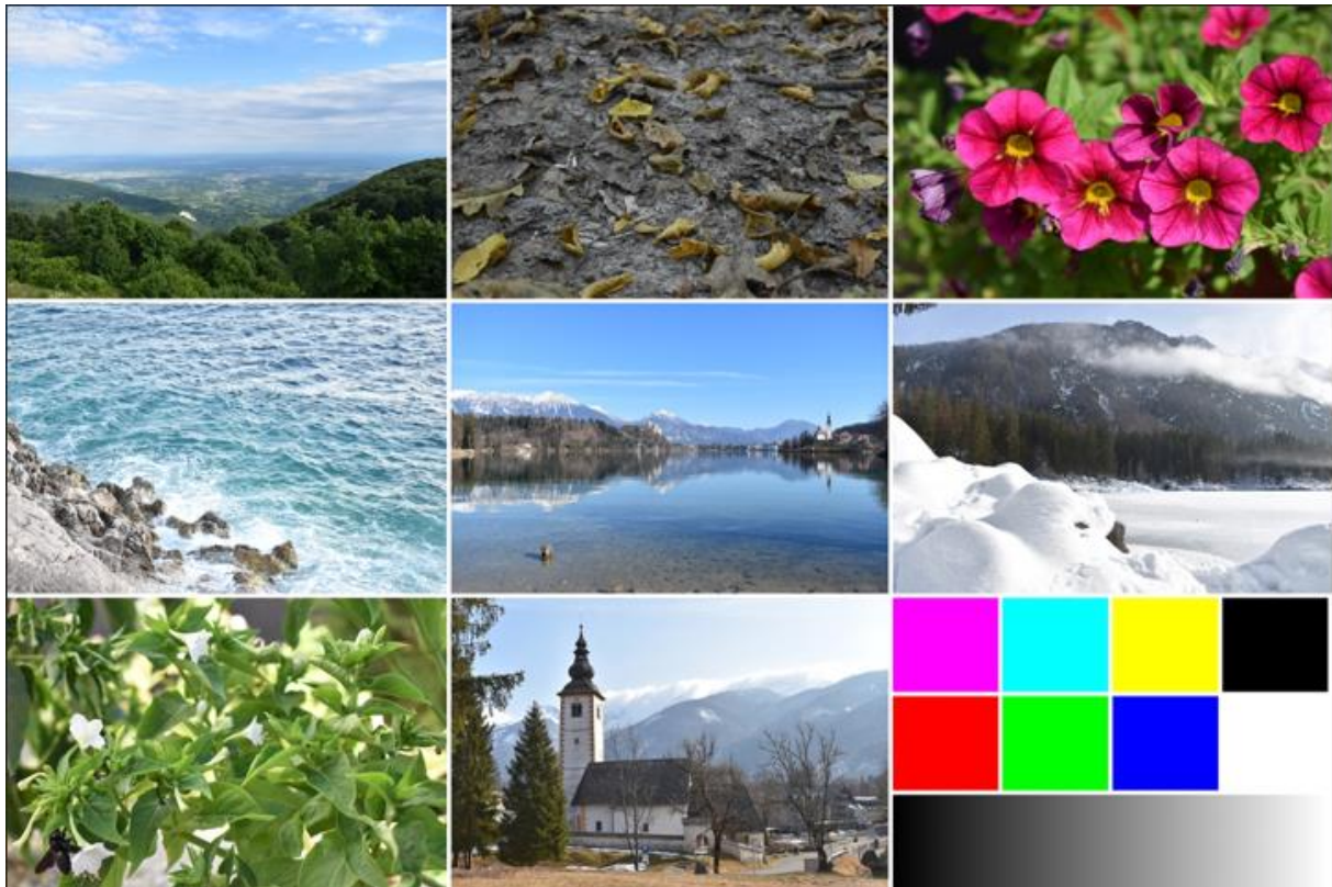
Slika 21. Testna forma u obliku kolaža različitih kompleksnih fotografija, boja RGB i CMYK te gradacije sivih nijansi, datoteka test_forma.png
