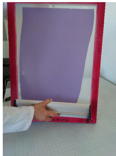
Slika 7 Oslojavanje mrežice fotoosjetljivom emulzijom
