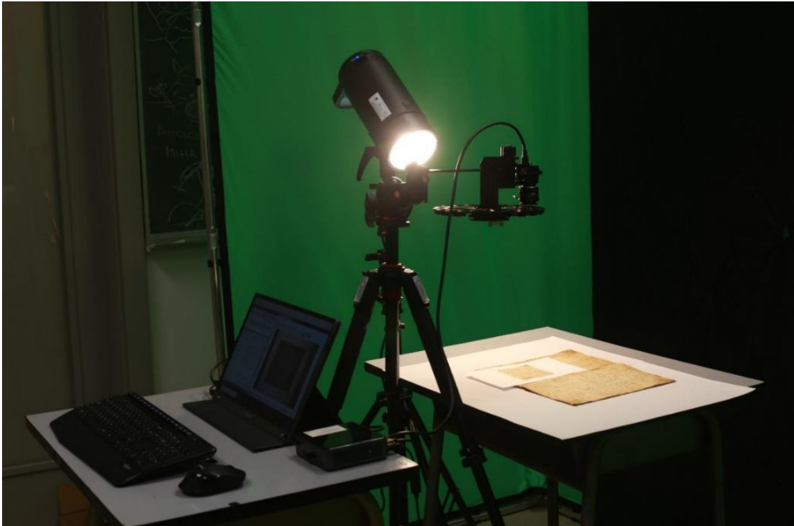
Slika 3: Postav multispektralnog sustava prilikom refleksijskog snimanja
