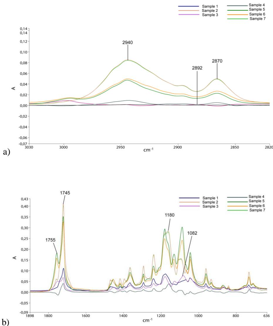
Slika 20. ATR FTIR spektri PLA/PCL filamenata pri valnim brojevima između:
