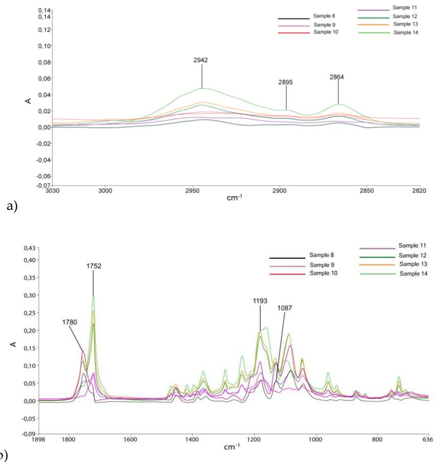
Slika 21. ATR FTIR spektri filamenata PLA/PCL/punilo na valnim brojevima između:
