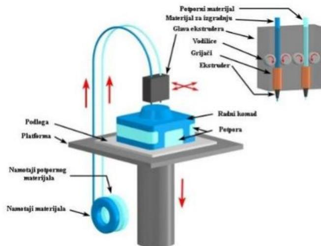
Slika 2. Princip FDM tehnologije
