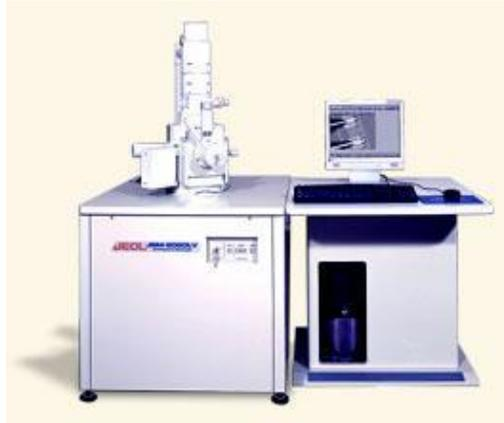
Slika 16. Uređaj JSM-6060 LV (Jeol)
