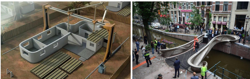
slika 11 (lijevo) - prikaz contour crafting metode. Koriste se velike strukture koje se montiraju iznad cijelog gradilišta i nanose materijal po principu sloj po sloj
