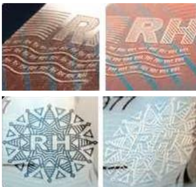
Slika 20 - Taktilne laminacijske strukture na PC identifikacijskoj stranici putne isprave RH
