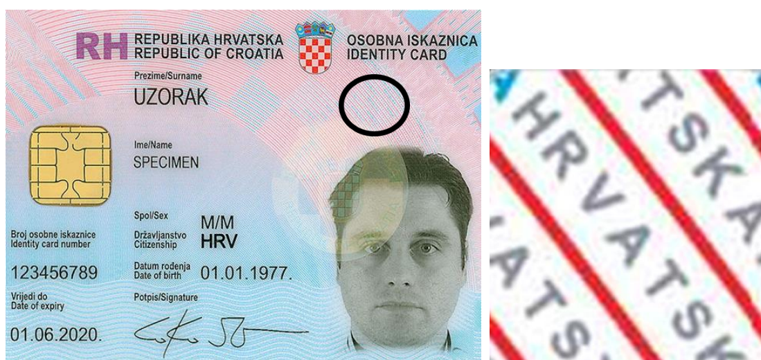
Slika 13- Elementi minitiska na hrvatskoj osobnoj iskaznici
