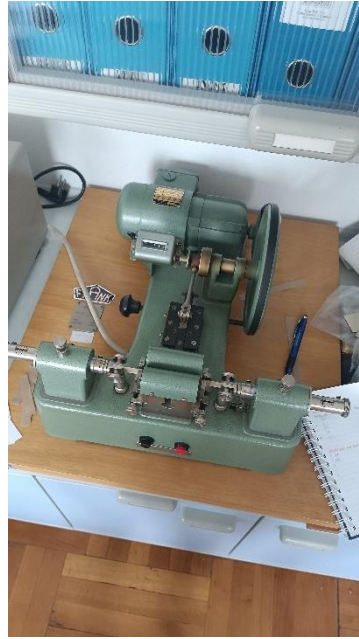
Slika 10. Uređaj za dvostruko savijanje papira
