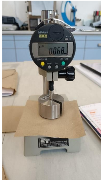
Slika 6. Elektronički ručni mikrometar za ispitivanje debljine papira, kartona i ljepenke
