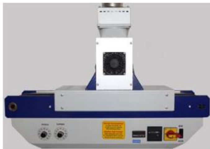
Slika 10. UV sušionik (Izvor: https://eprints.grf.unizg.hr/3264/1/DB879_Penava_Ivan.pdf )
