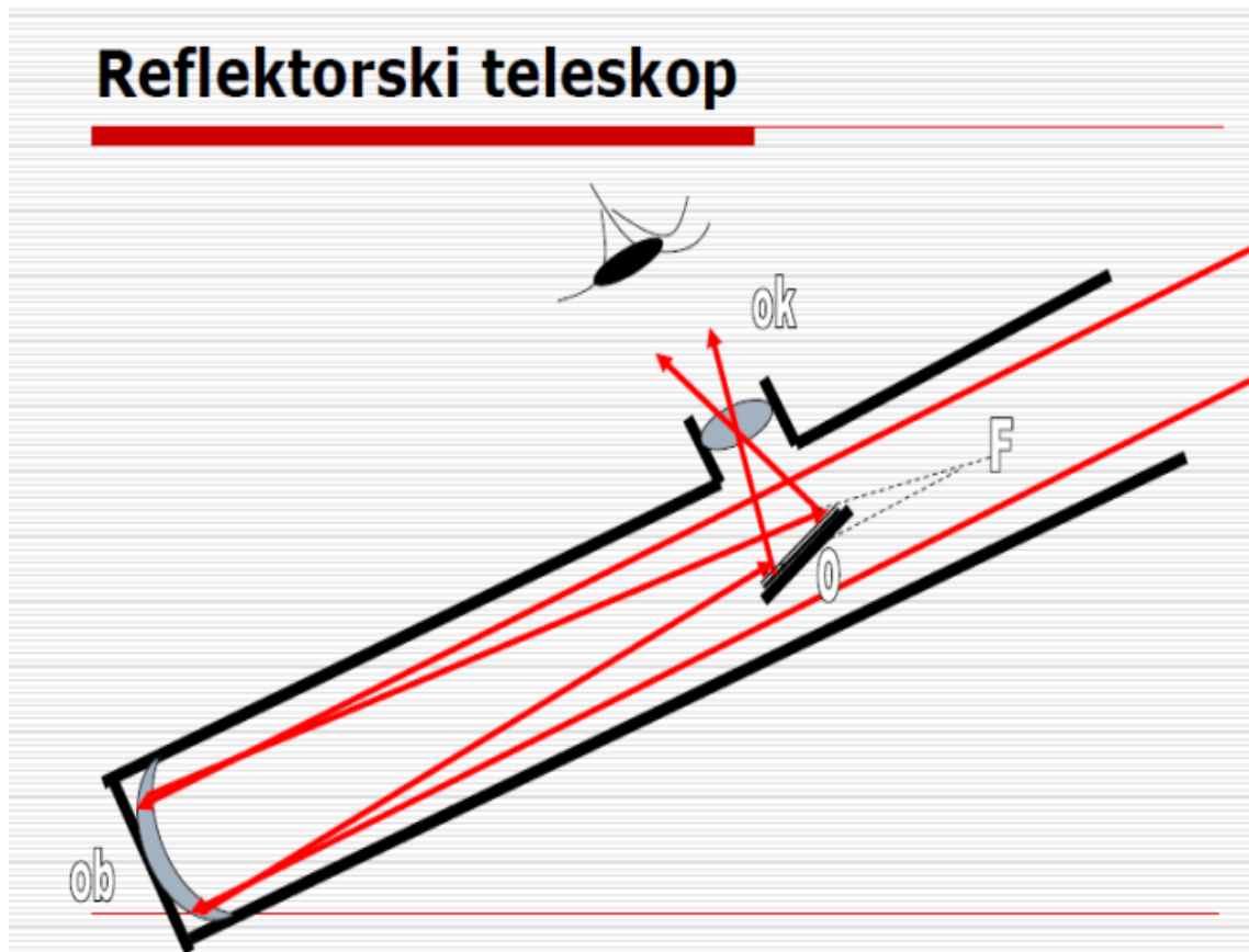
Slika 6: Princip rada reflektorskog teleskopa Izvor: https://www.emaze.com/@AWQWFTRF/Untitled
