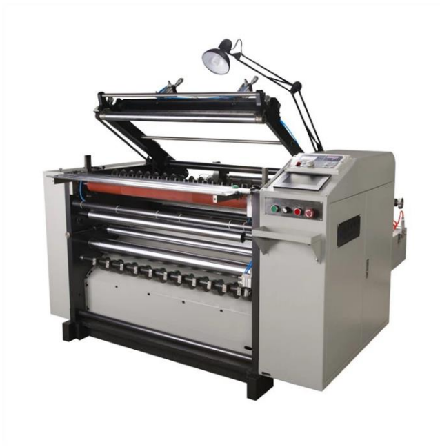
Slika 4. Stroj za rezanje rola [12]
