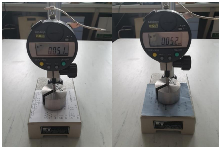
Slika 11. Određivanje debljine termičkih papira
