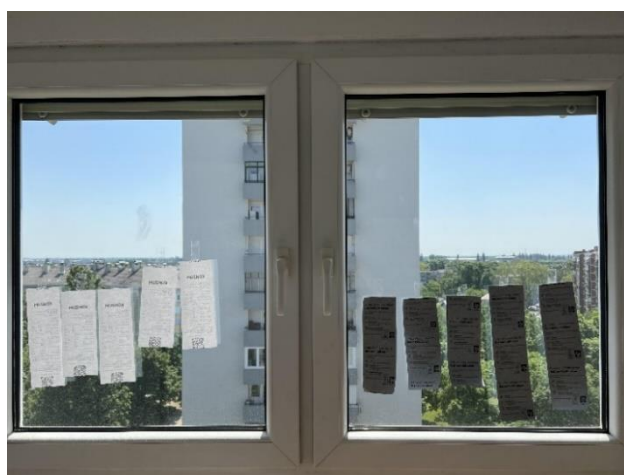
Slika 7. Postavljanje uzoraka na južnu stranu svijeta zbog ispitivanja stabilnosti na svjetlost
