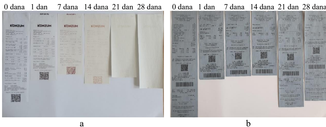
Slika 20. Utjecaj perioda izlaganja uzoraka svjetlosti (0, 1, 7, 14, 21 i 28 dana) na stabilnost računa ispisanih na: a) bijelom papiru; b) plavom papiru
