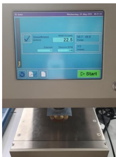
Slika 12. Mjerenje glatkosti papira
