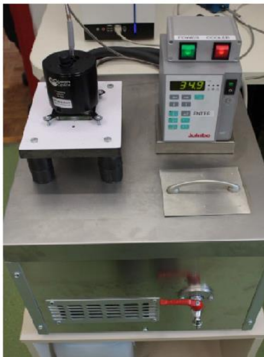
Slika 10. Termostatički cirkulator i spektrofotometar u fazi mjerenja uzoraka
