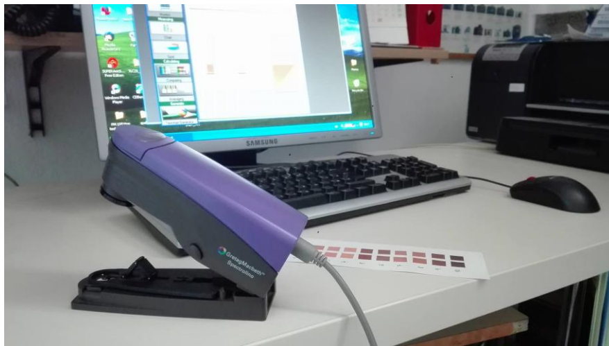
Slika 09: Gretag Macbeth Spectrolino ( 45^{\circ}a:0^{\circ} ): Izvor: autor
