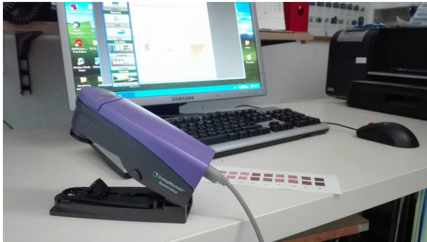
Slika 09: Gretag Macbeth Spectrolino ( 45^{\circ}a:0^{\circ} ): Izvor: autor
