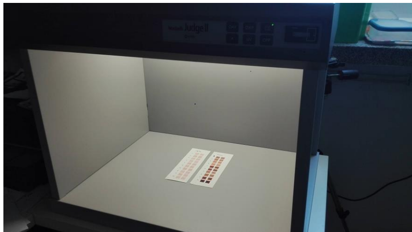
Slika 11: Promatranje uzoraka u kućici za ocjenjivanje pod rasvjetom TL84:
