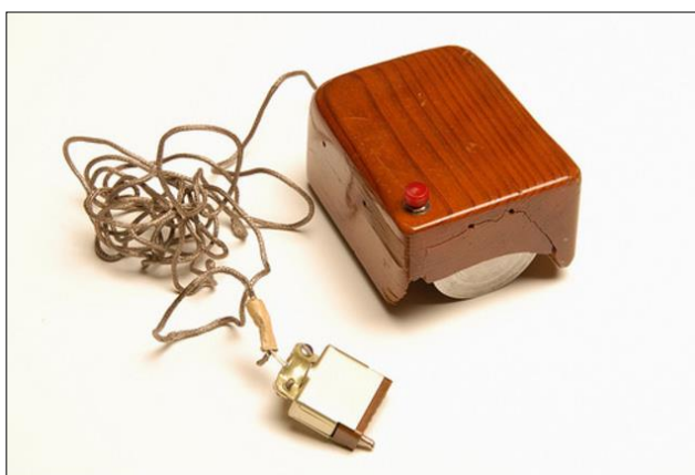
Slika 4. X-Y Position Indicator
