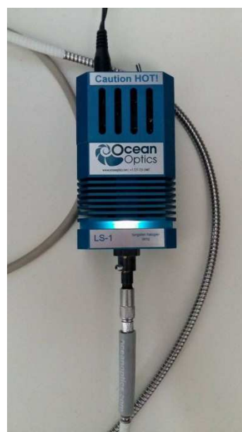
Slika 8. izvor svjetla Ocean Optics LS-1
