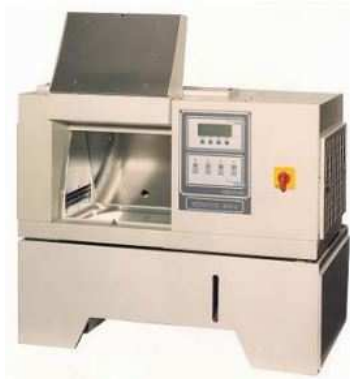
Slika 6. SOLARBOX 1500e uređaj korišten za starenje uzoraka
