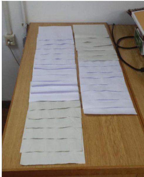
Slika 9.: Pripremljeni uzorci papira nakon lijepljenja i prešanja
