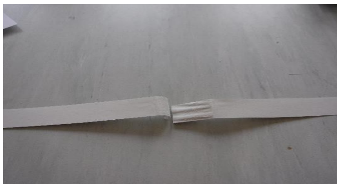
Slika 11.: Prikaz uzorka nakon provedenog testa ljuštenja
