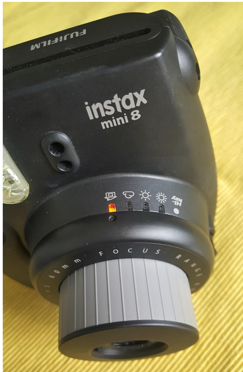
Slika 26. Prikaz objektiva i pomičnog prstena s oznakom
