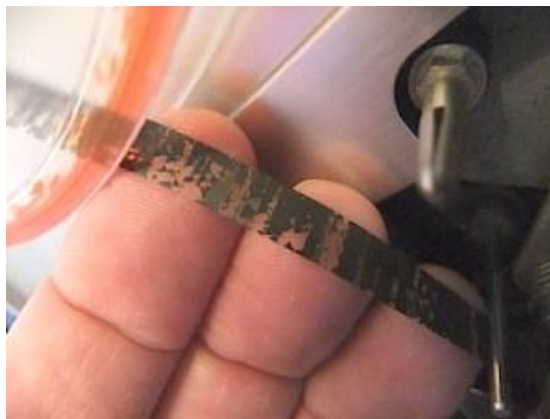
Slika 25. Oštećena magnetna vrpca pogođena sticky-shed sindromom
