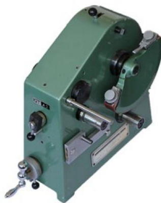
Slika 13. Instrument za određivanje kvalitete obojenja otisnutog materijala brzine otiskivanja 1,35 / 3,5 m/s i sile otiskivanja 100 – 800 N
