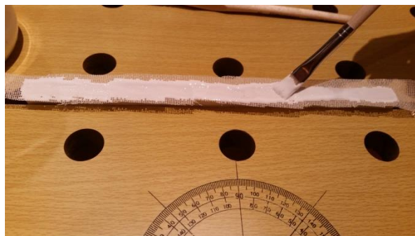
Slika 18. Lijepljenje gaze na hrbat knjižnog bloka
