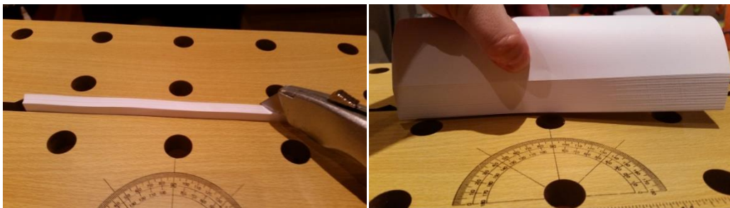
Slika 17. Urezivanje kosih utora na hrbat knjižnog bloka i savijanje hrpta u lepezu
