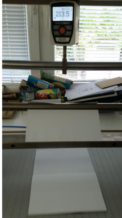
Slika 22. Trenutak kidanja lista iz knjižnog bloka i prikazana sila Fotografija autora
