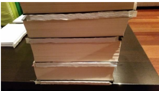
Slika 19. Sušenje knjižnih blokova pod utezima
