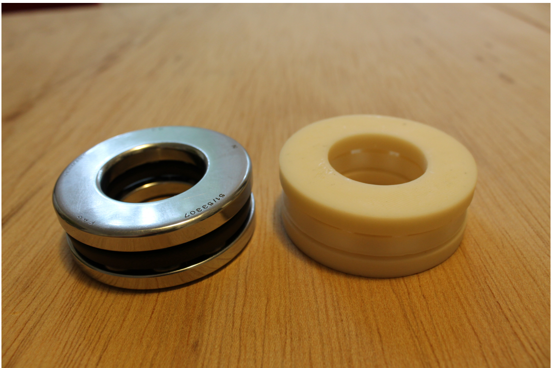
Slika 50. Originalan kuglični ležaj i isprintani model
