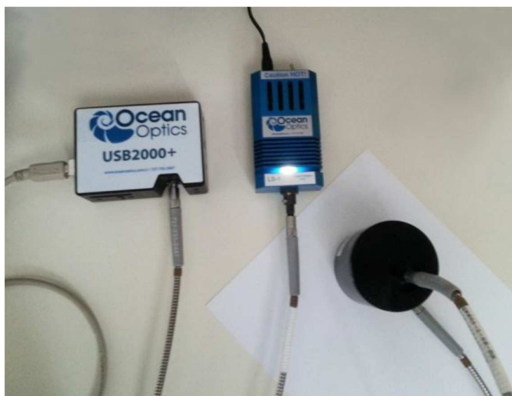
Slika 10. Mjerenje kolorimetrijskih promjena pomoću spektrofotometra Ocean Optics USB 2000+ [18]
