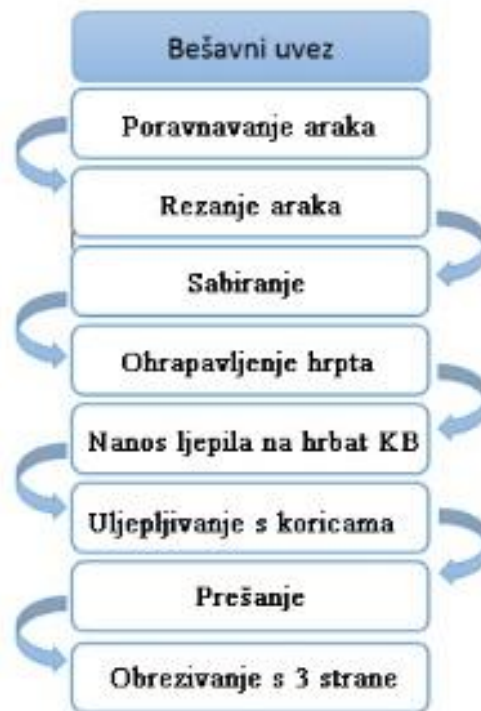
Slika 26. Tehnološka shema meko uvezane knjige - bešavni uvez
