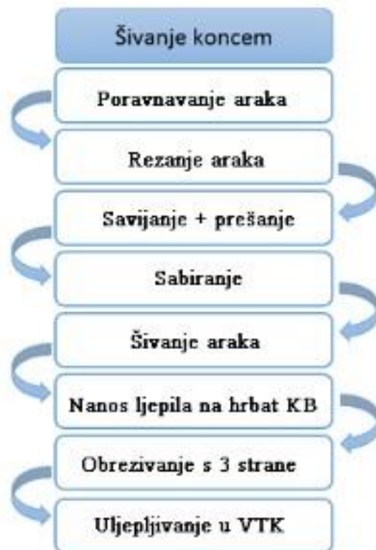
Slika 28. Tehnološka shema TUK – šivanje koncem
