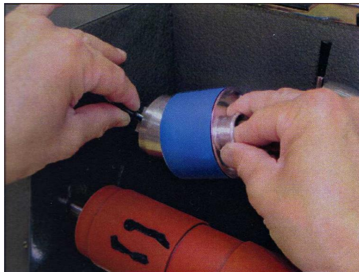
Slika 11. Montaža tiskovne forme na nosač kako bi se mogla aplicirati boja sa gumenog valjka na tiskovnu formu
