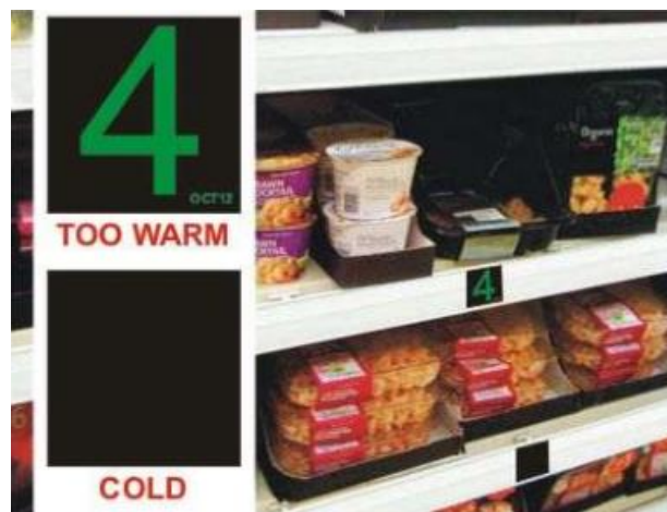
Slika 1. Tekući kristali se koriste kao indikatori topline kada je potrebno precizno odrediti temperaturu proizvoda kao što je meso i mesni proizvodi te lako kvarljiva hrana. Na indikatoru se na crnoj podlozi pokaže broj 4 što znači da je temperatura previsoka (viša od 4°C) te da se sastav unutar pakiranja može pokvariti ili je već pokvaren.
