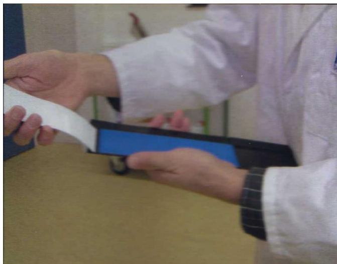
Slika 12. Montiranje uzorka papira na nosač tiskovne podloge
