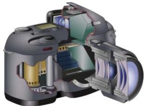
Slika 9. Film u fotoaparatu, presjek
