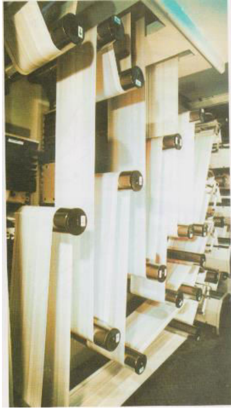
Slika 10. Sustav za regulaciju napetosti trake pri prolasku u aparat za savijanje 64 stranica ( LITHOMAN III )
